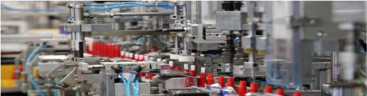
Abbildung 6 Montageautomat für Kugelschreiber
